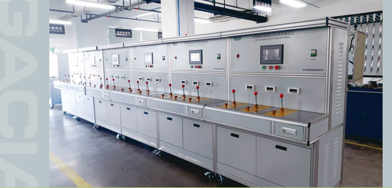
MCB人工延时校验单元 MCB Artificial Delay Check Unit
