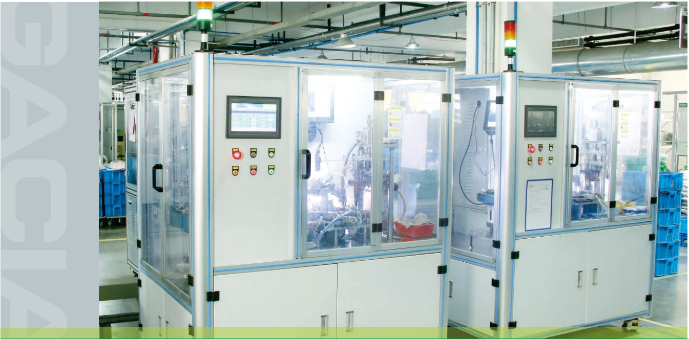
小型断路器静组件自动焊接单元 MCB Automatic Welding Unit for Static Components
