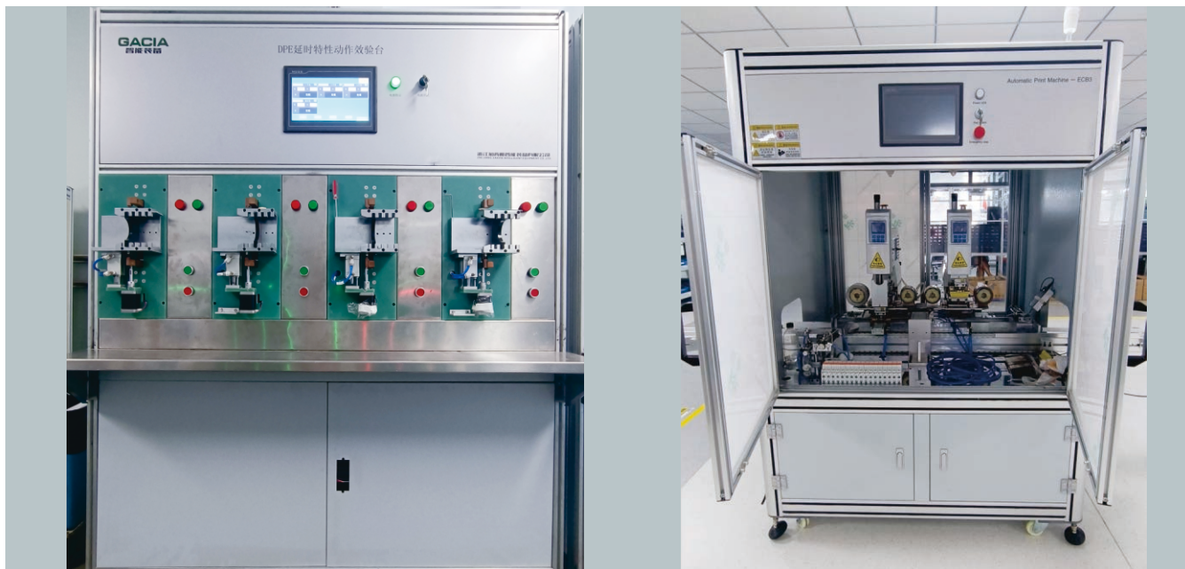
阿尔及利亚断路器半自动校验台 Algerian Semi-automatic Calibration Test Bench
