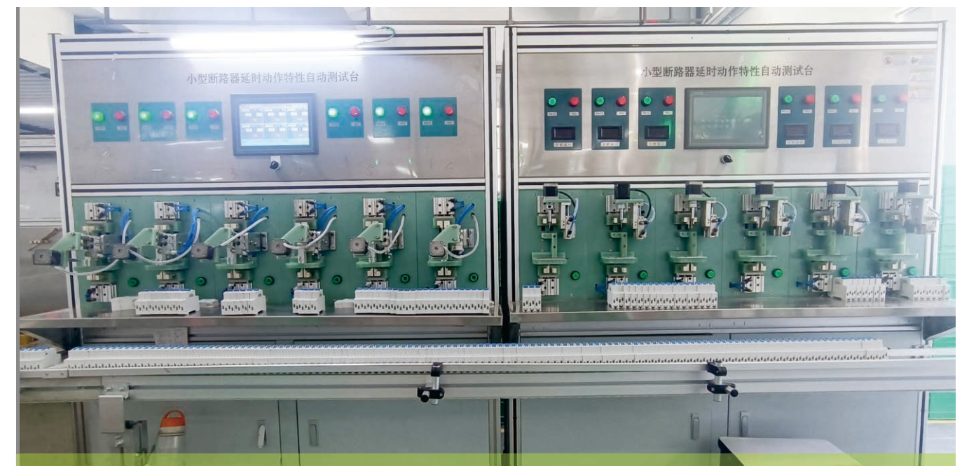
6KA 10KA 1P+N 半自动校验台 6kA 10kA 1P+N Semi-automatic Calibration Table
