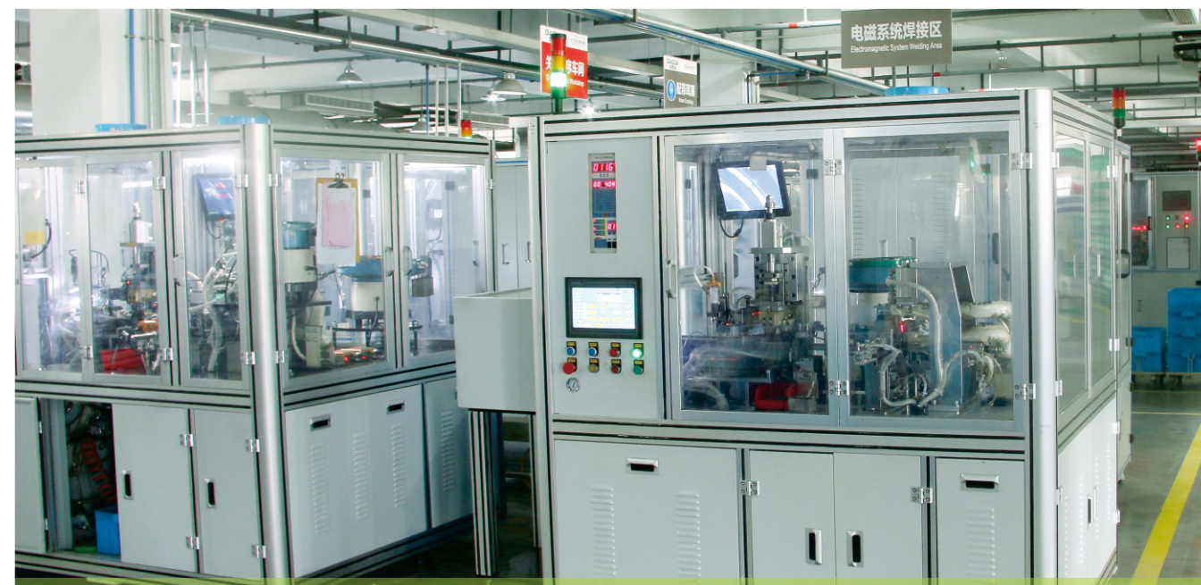
小型断路器热组件自动焊接单元 MCB Automatic Welding Unit for Hot Components
