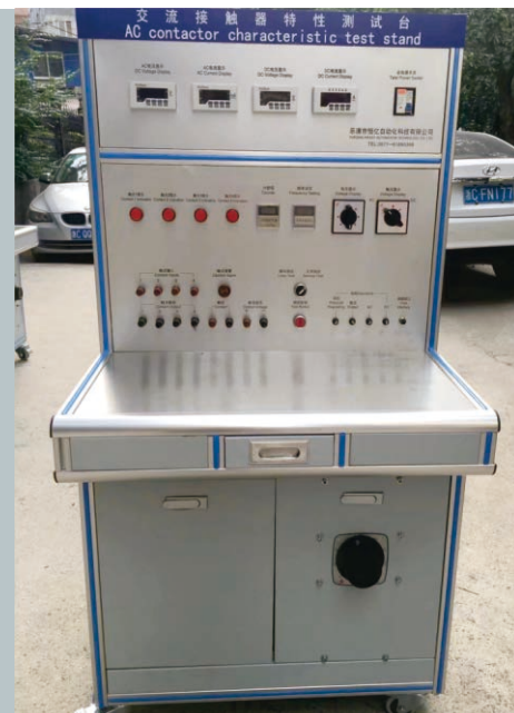
交流接触器特性测试台 AC Contactor Characterization Test Bench
